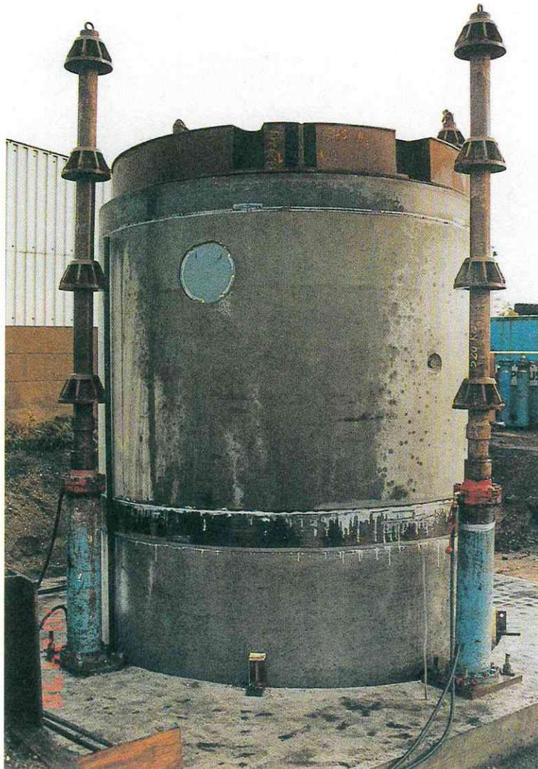
**Abb. 2:** Betonsegment mit Schachtwanddurchführung
