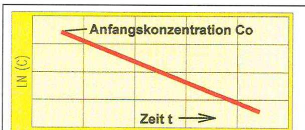
Abb. 1: Verdünnungslog im Grundwasser zur Bestimmung der Filtergeschwindigkeit  $v_f$
