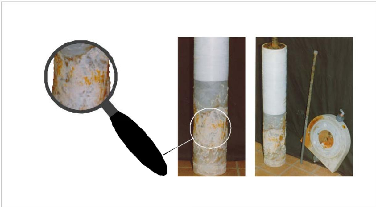
**Abb. 4:** Salzablagerungen auf der Diaphragmaoberfläche (Anolytseite)
