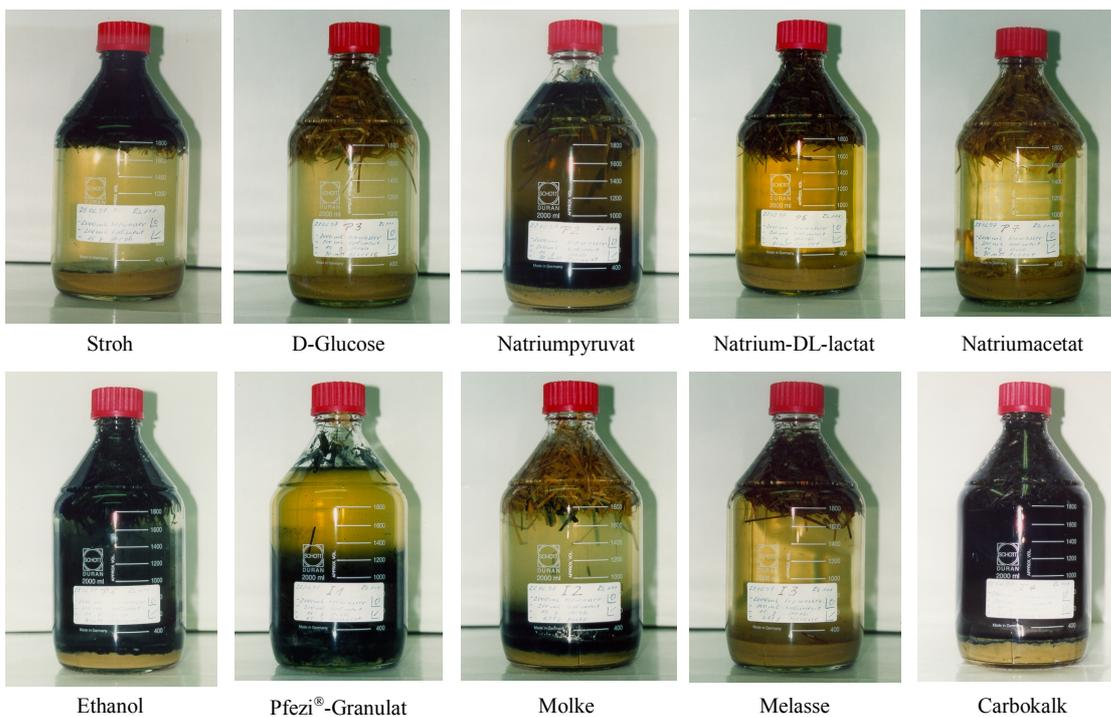
Versuche posttoxischem Sediment des RL-111 aus einer Wassertiefe von 7,0 m (Endzustand nach 52 Wochen)
