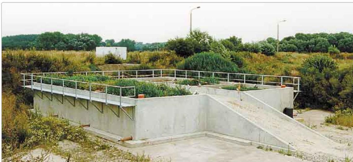
Bild 5: SECON-Versuchsanlage in Kleindalzig zur Vererdung von Baggerschlamm (Quelle: Andreas Zehnsdorf, UFZ)
