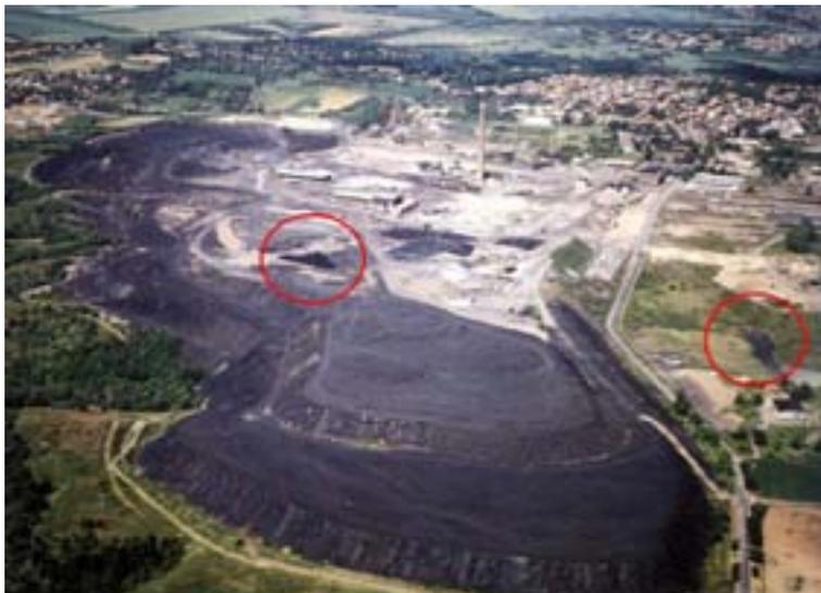
**Abb. 32** Die Schlackehalde der ehemaligen Kupferhütte Helbra (Stand 1995) mit ca. 30 Mio. t Schlacke. Im ehemaligen Teich 9 (linker Kreis), angelegt auf der Halde, wurden einige 10 000 t Flugstaub (Theisenschlamm) deponiert. Durch Winderosion wurde der Flugstaub auch in die Umgebung (rechter Kreis, Quelle des Flüsschens Glume) verfrachtet. Foto aus SCHMIDT (2004), verändert.
