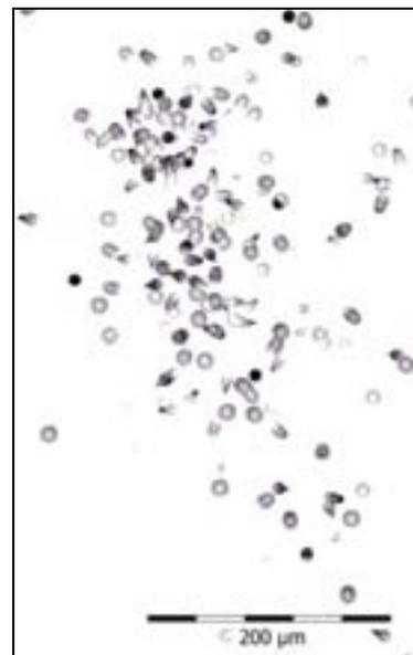
Spektrum, REM-Aufnahme und Spurbild eines Clusters der Theisenschlamm-Probe 361 (Markierung t). Es handelt sich bei dem Korn in der Bildmitte um eine Verwachsung von gediegenem Pb (weiß) mit ZnS (grau). Gediegen Pb, ohne Beimischungen von S, wird in den Theisenschlamm-Proben immer von Cluster-Spurmustern nachgezeichnet. Diese Cluster-Spurmuster zeichnen meist die Form des Pb-Partikels nach.
