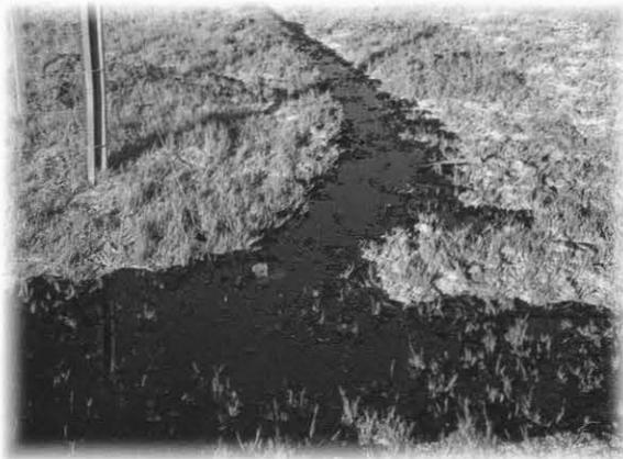
Bild 2 Mineralölkontamination
