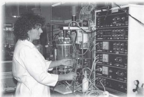
*Bild 4 Gerätekonfiguration zur Kultivierung von Mikroorganismen (Fermenter) mit peripheren Geräten zur Steuerung und Kontrolle der Substratzufuhr sowie zur on-line Messung zellulärer Signale und Parameter der Substratkonversion.*
