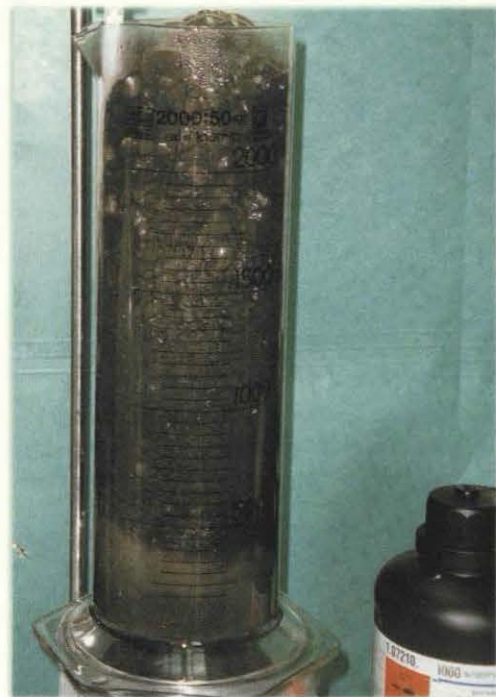
Bild 5: In der zweiten Phase des Oxidationsprozesses steigt die Temperatur rasch auf circa 97 Grad Celsius an. (Foto: Birgit Daus)
