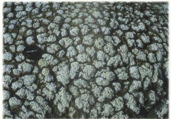
Bild 2: Oberfläche von ausgetrocknetem Theisenschlamm, weiß: Ausblühungen von Zinksalzen (Foto: Holger Weiß)
