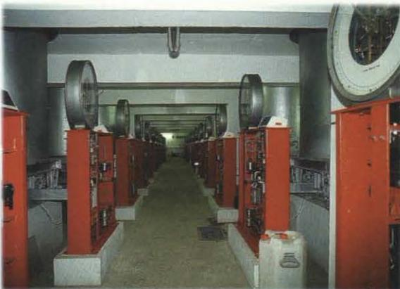
*Bild 6: Ansicht des Lysimeterkellers der Anlage Brandis mit 24 auf Waagen stehenden Lysimetern. (Foto: Norma Neuheiser, UFZ)*
