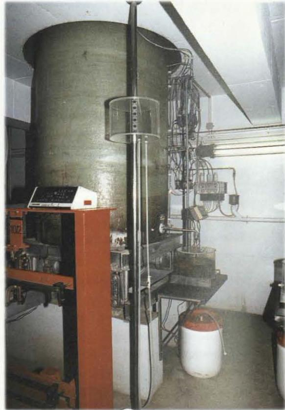
*Bild 7: Im Lysimeterkeller von Brandis eingebautes Lysimeter von der »Braunkohlentagebaukippe Espenhain« bei Rötha (korrespondierendes Bodenprofil siehe Bild 2). Es sind die Wägeeinrichtung, die Sickerwassermengenerfassung, einzelne, auf unterschiedliche Ebenen verteilte, eingebaute Messfühler und Teile der dazugehörigen Steuerung sowie das Gefäß zum Wassereinstau (Grundwasserwiederanstieg) zu erkennen. (Foto: Norma Neuheiser, UFZ)*
