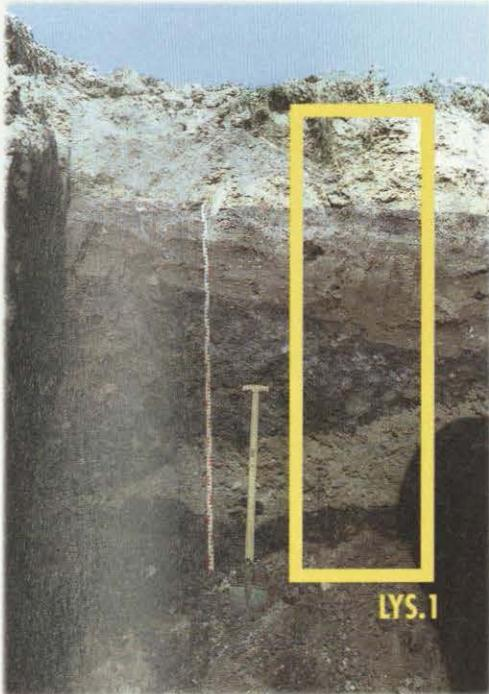
Bild 2a: Bodenprofil am Lysimeterentnahmeort »Rekultivierte Braunkohlentagebaukuppe Espenhain« bei Rötha. Die ausgegrenzte Fläche (Bezeichnung Lys.1) kennzeichnet den Profilaufbau im Lysimeterquerschnitt.
