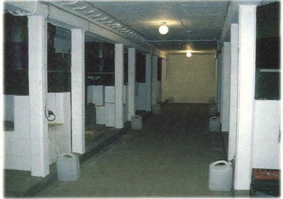
*Bild 9: Blick in den Lysimeterkeller der mit unterschiedlicher Heidevegetation bedeckten wägbaren Lysimeteranlage in der Colbitz-Letzlinger Heide (Foto: Holger Rupp)*
