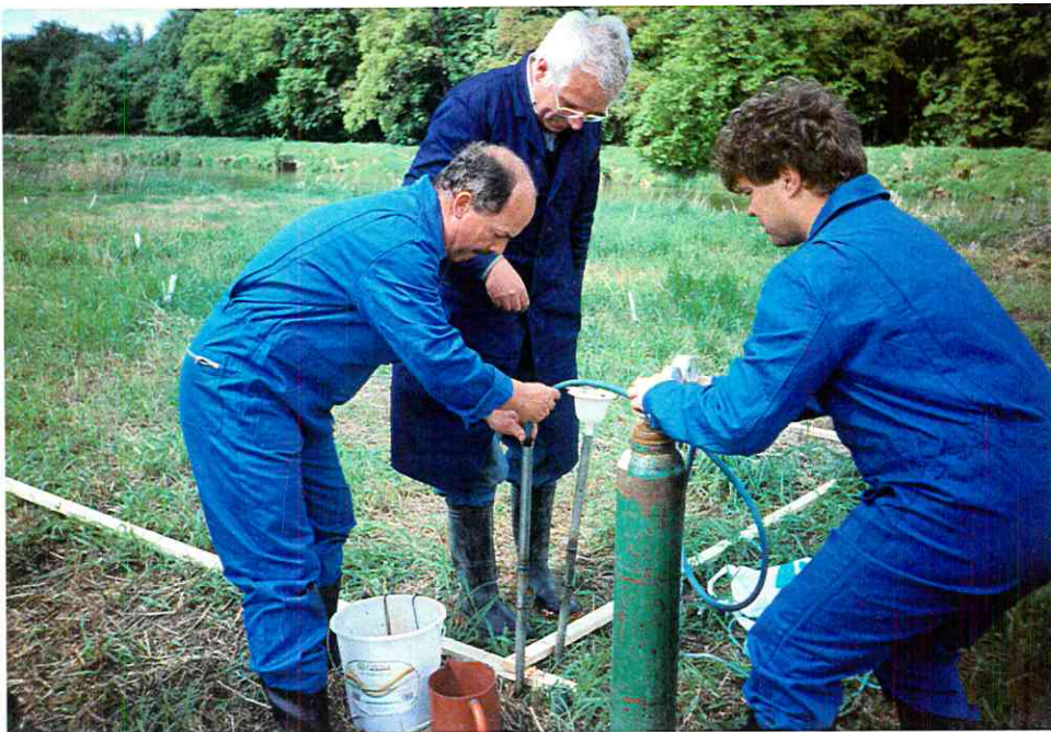
Abb. 11: Einbringung von Biodekon in die Bodentiefe 30-40 cm auf der Fläche G1
