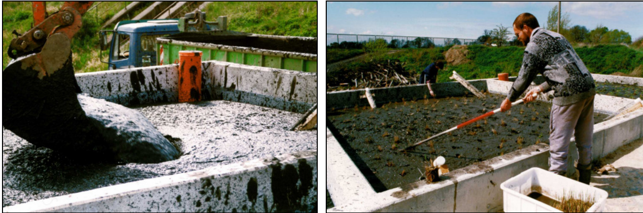
Abb. 118: Befüllung der Pilotanlage SECON mit anoxischem, schlammig-pastösem Sediment (rechts) und Bepflanzung der Sedimentoberfläche eines Versuchsbeckens mit Phragmites australis im April 1999 (links)
