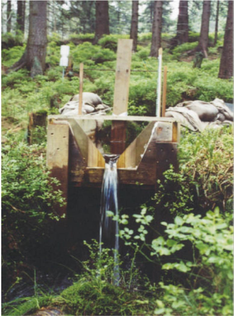
**Anlage 20: ITNI-Messsystem (Integral Total Nitrogen Input)**
