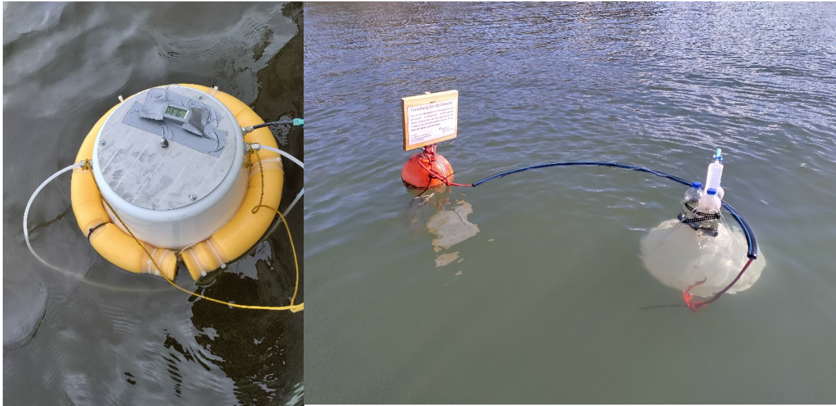
Bild 1: Schwimmkammer (a) und Blasenfalle (b) zur Messung aquatischer THG Fluxe. Fotos: M.Koschorreck.
