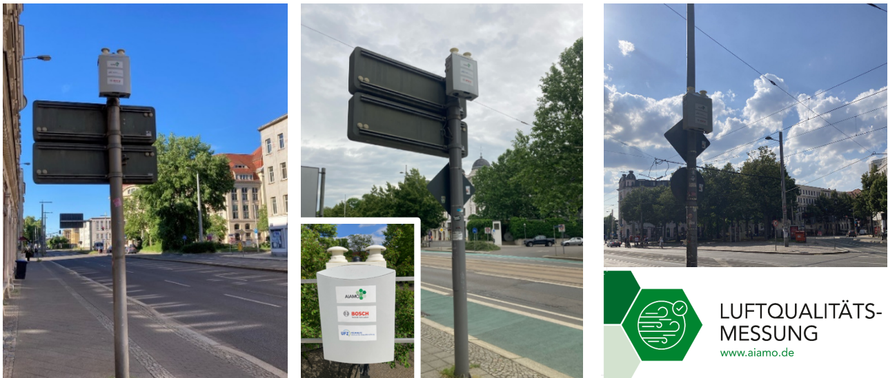
Abbildung 1: IMB (Immission Monitoring Box) Luftqualitätssensor der Firma Bosch und Installationen an Parkleitsystemen und Stadtlaternen
