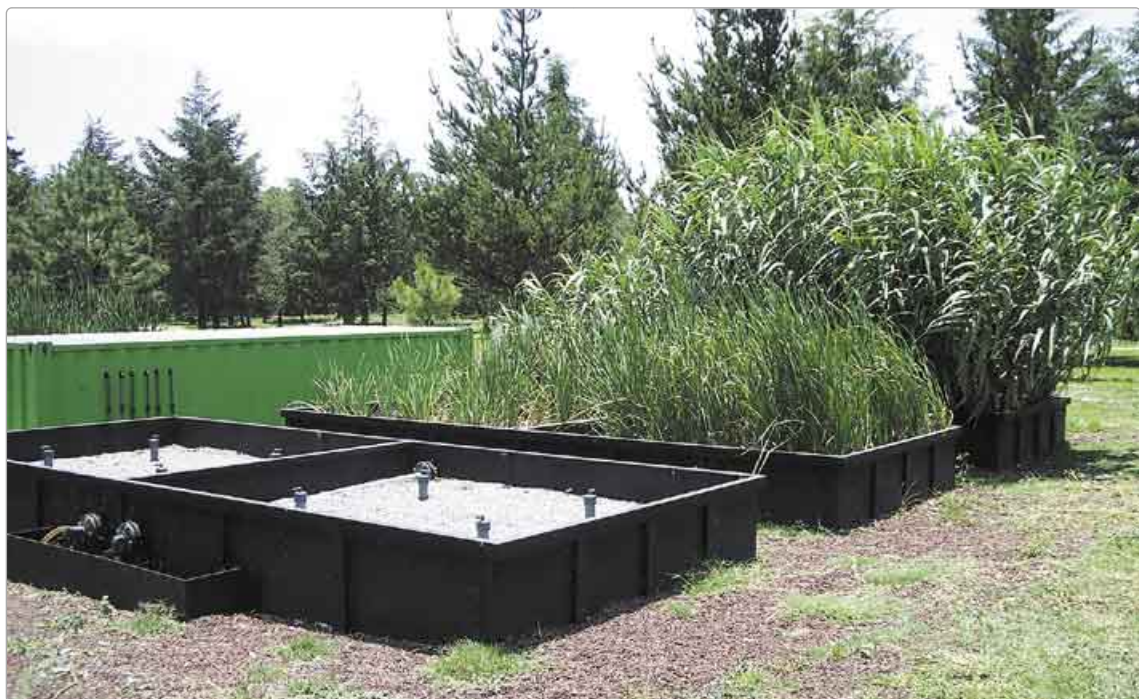
Der Vergleich zeigt bepflanzte und unbepflanzte Vertikalbeete der Anlage der Umweltschutz Nord GmbH im Park »Xochitla«. (Quelle: Umweltschutz Nord GmbH)
