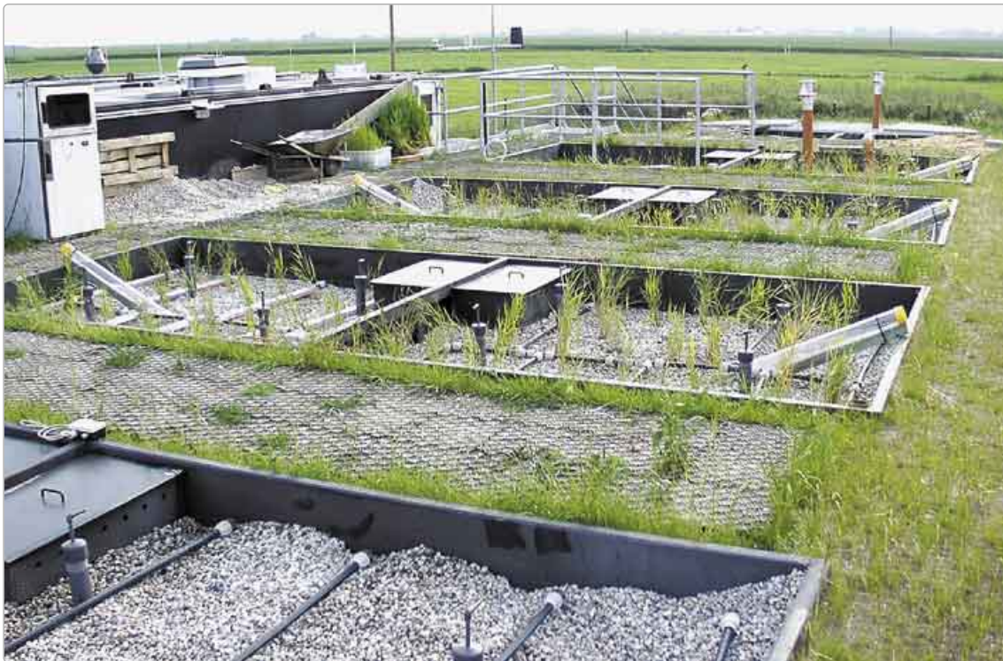
Nach der Bepflanzung mit Schilf ( Phragmites australis ) dauert es an mitteleuropäischen Standorten wie Langenreichenbach zwei Vegetationsperioden, bis das Substrat vollständig von Wurzeln durchzogen ist. (Quelle: Dr. Oliver Bederski, UFZ)
