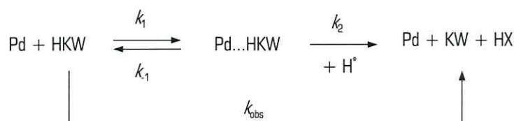
Abb. 4.1-12: Reaktionsschritte der Hydrodehalogenierung von HKW an Pd-Katalysatoren
