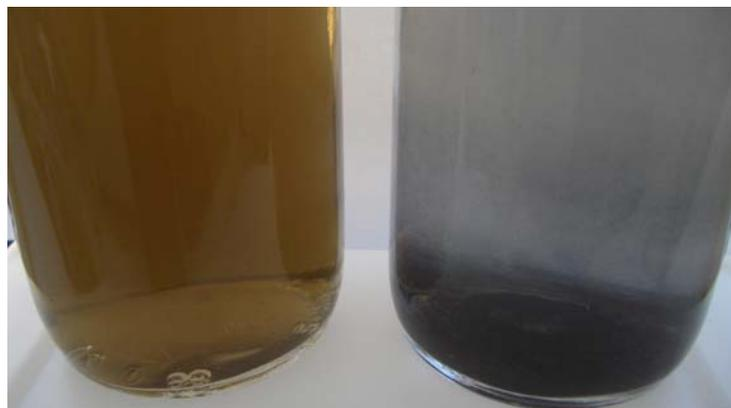
Abb. 4-19: Einfluss von Roth-HA auf die Stabilität von kolloidalen  $\text{Fe}(0)$ -Suspensionen ( $C_{0,\text{Fe}(0)\text{BH}} = 200 \text{ ppm}$ , links  $C_{\text{Roth-HA}} = 50 \text{ ppm}$ ; rechts  $C_{\text{Roth-HA}} = 0 \text{ ppm}$ ;  $t = 24 \text{ h}$ )
