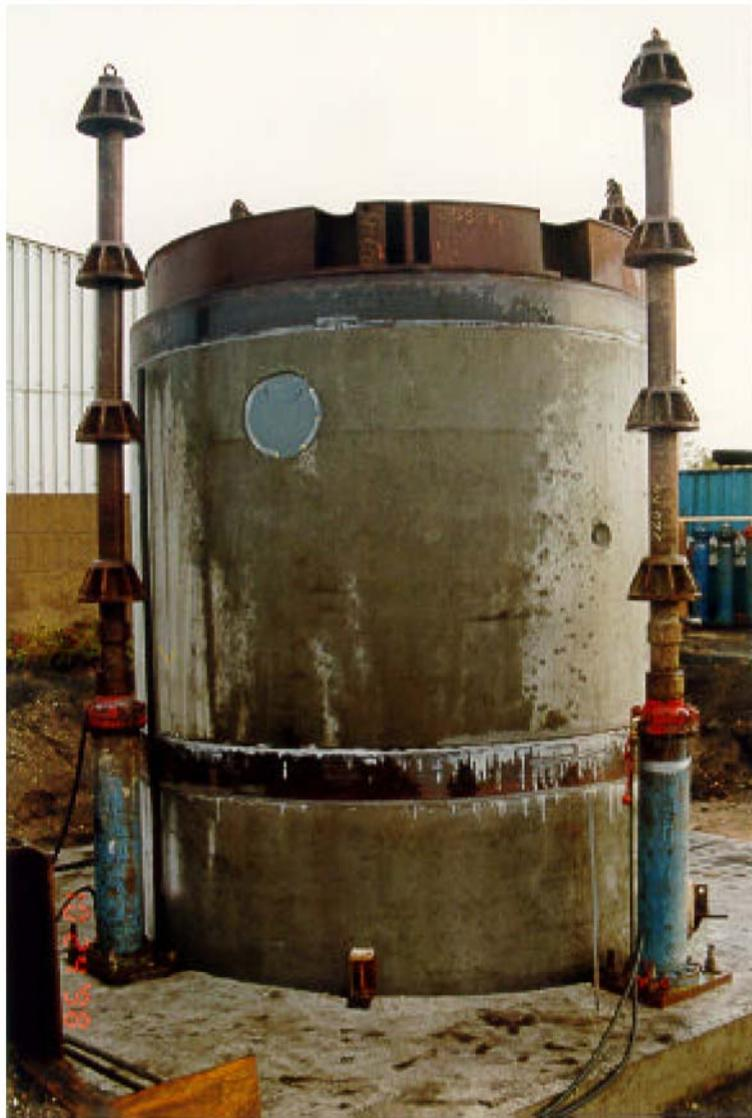
**Abb. 2:** Betonsegment mit Schachtwanddurchführung
