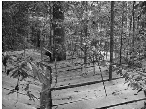
**Abbildung 8.8:** Foto eines "Troughfall Exclusion" Niederschlags-Experiment im Amazonas. Es wurden ein Hektar Waldfläche mit Plastik-Platten ausgelegt um den Regen abzufangen. Foto aus [Fisher et al. \(2007\)](#).
