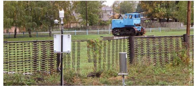
Klima- und Bodenfeuchte-Messtation im Testgebiet Perwomayskij (mit Denkmal für Traktor der Neuland-Kampagne).
