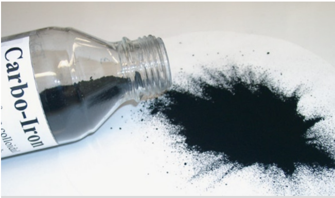
Das am UFZ entwickelte Carbolron™ ist ein Verbundmaterial aus Mikroaktivkohle und Nanoeisen. Carbolron wurde für den direkten Einsatz in belasteten Grundwasserleitern optimiert. Foto: Dr. Robert Köhler/UFZ
