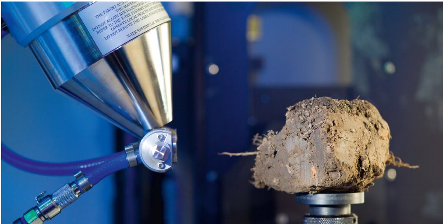
Die Röntgentomographie – kurz CT – erlaubt Einsichten in die ungestörte Struktur von Böden mit einer Auflösung bis zu fünf Mikrometern.
