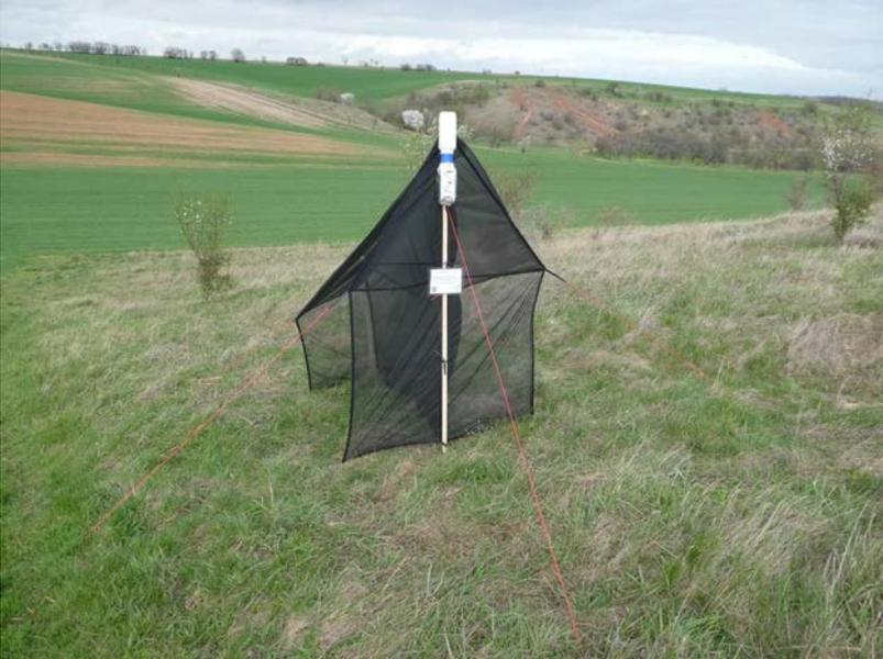
**Abb. 1:** Malaise-Falle aufgebaut (seitliche „Flügel“ sind rechtwinkelig abgespannt); wichtig: die bodennahen Ränder sollten möglichst nah an der Bodenoberfläche abschließen! Die Schlaufen vorn und hinten kann man einmal um den Stab wickeln und dann mit einem Häring befestigen (s. Abb. 3), dann rutscht auch nichts nach oben. Die anderen Schlaufen kann man z.B. durch einen Knoten verkürzen.
