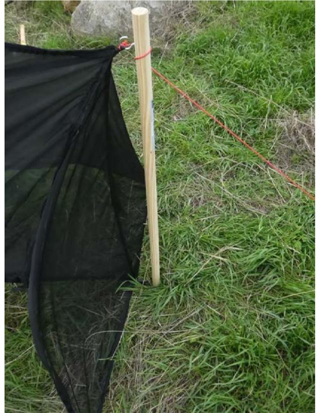
**Abb. 5: Links** – Stoff mit Schlauchschelle an Kopfdose befestigen, Kopfdose am Stab mit weiterer Schlauchschelle befestigen, Vorderseite der Falle mit Schlaufen am Stab befestigen; mit Rundholz o.ä. ein Loch von ca 15 cm Tiefe in den Boden stechen; **Rechts** – hintere Stange in den Boden schlagen (oder in das vorbereitete Loch stecken), Hinterseite der Falle einhängen und abspannen.
