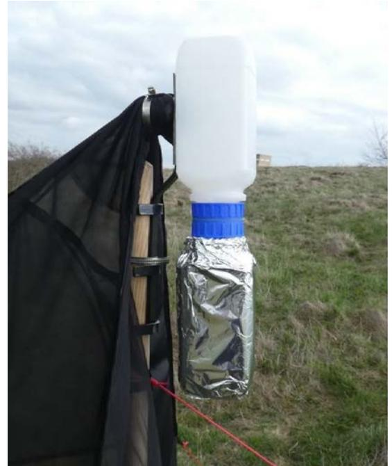
**Abb. 2:** Montage Kopfzose und Fangflasche an der 1,80 m Stange mit Schlauchschellen (eine Schlauchschelle für die Befestigung am Stab reicht). Die Fangflasche ist zum Schutz vor Wärme und UV-Strahlung mit Haushalts-Aluminiumfolie umwickelt.
