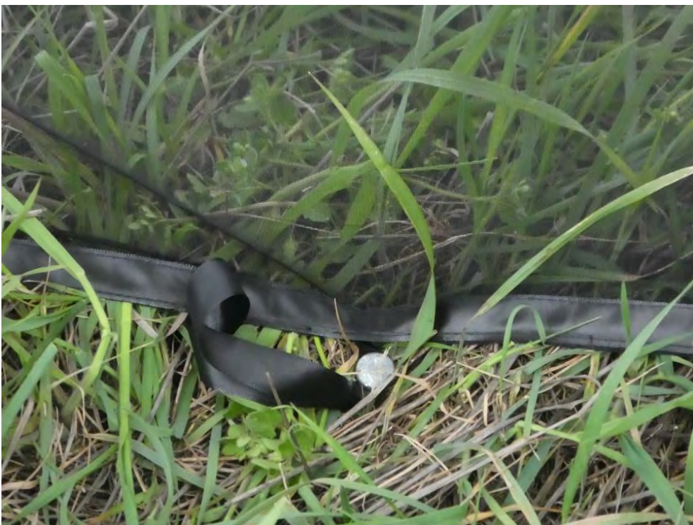
Abb. 7: Demonstration Bodenabschluß. Mit einem Knoten in der Schlaufe kann man den Unterrand der Falle mit einem Häring oder Nagel gut zum Boden ziehen.
