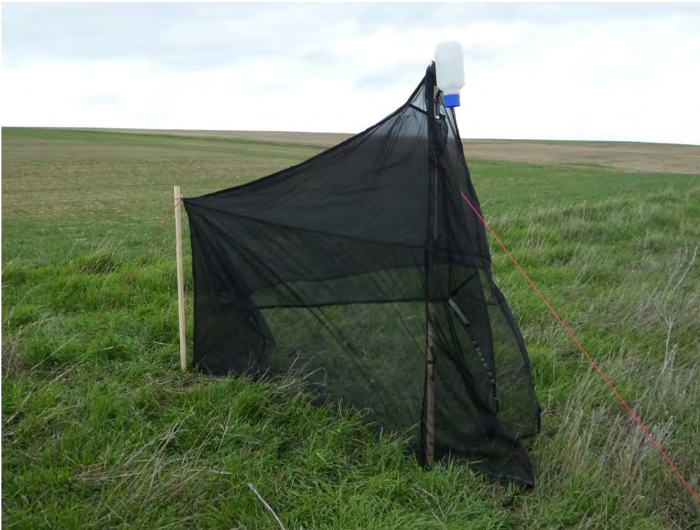
Abb. 6: Mittelwand zum Boden abspannen. Darauf achten, dass die Falle gut zum Boden abschließt, damit auch Insekten, die sich auf der Bodenoberfläche bewegen, gefangen werden!
