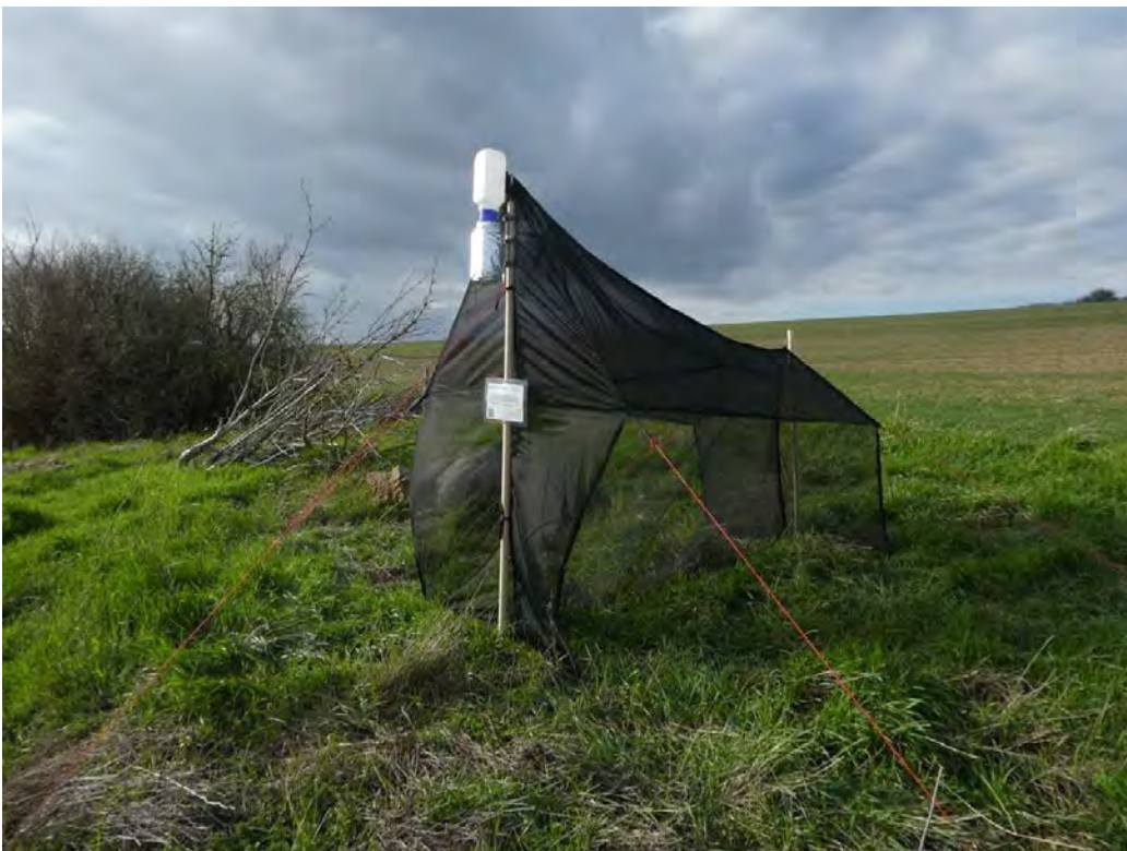
Abb. 9: Alles abgespannt, alufolienumwickelte Fangflasche aufgeschraubt - fertig!
