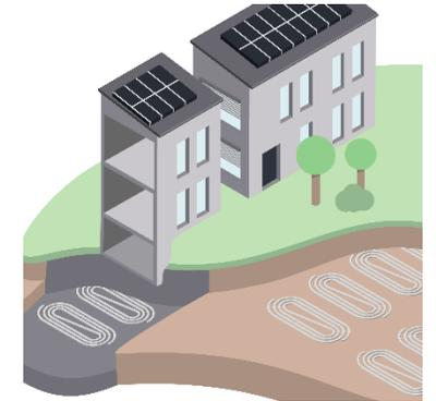
Erdwärmekollektoren unter Gebäuden & in der Freifläche
