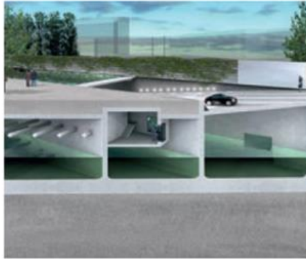
48 Querschnitt durch Tiefgarage mit Retentionsfunktion
