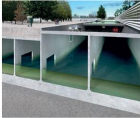
47 Nutzung der Lufträume unter der Rampe einer Tiefgarage zum Rückhalt von Abflussspitzen
