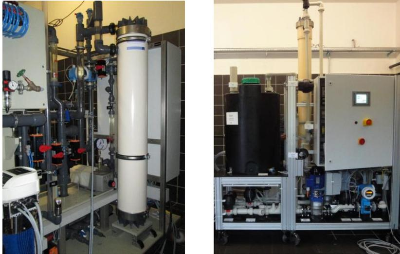
Abb. 8: Kleintechnische Versuchsanlagen zur Ultra- und Mikrofiltration im Wasserwerk Muldenberg
