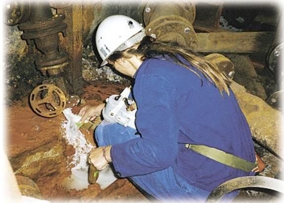
Bild 5: Wasserprobenahme in einem ausgedienten Uranscht (Foto: Barbara Hard)
