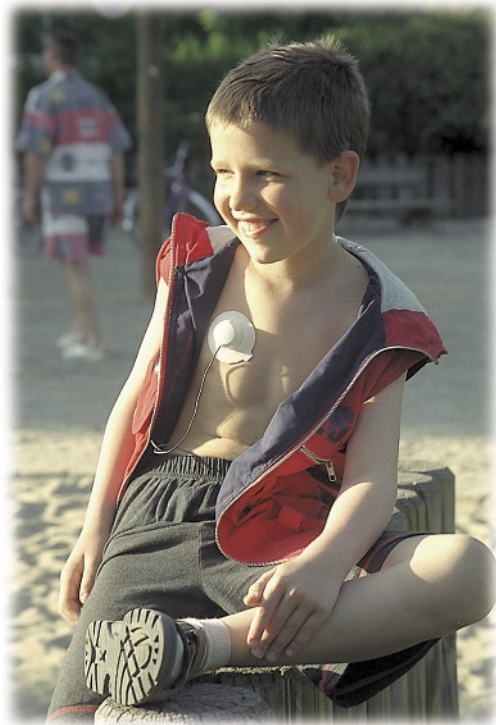
Bild 8 b) Auch in der nächsten Phase setzte sich der Sensor noch aus diesen beiden Teilen zusammen, jedoch schon wesentlich kleiner. (Foto: Doris Böhme, UFZ)
