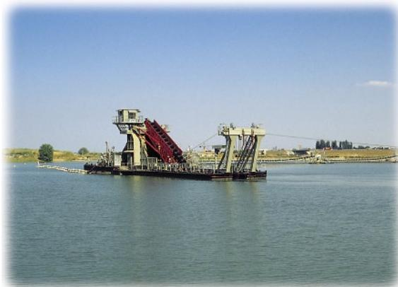
*Bild 10: Förderung von Sand und Kies mit Hilfe eines Schwimmbaggers bei Barleben (Ohrekreis) (Foto: Mathias Scholz, UFZ)*
