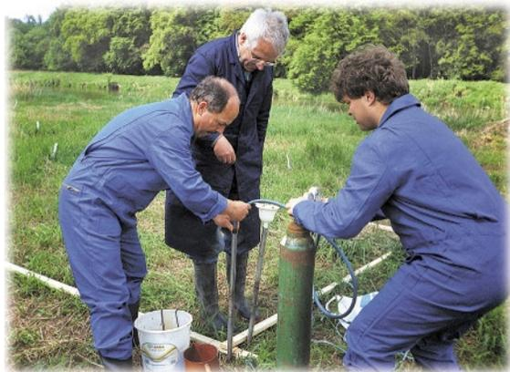
**Bild 5: Einbringung der Nährsubstrate in die Bodentiefe von 30-40 cm auf der Fläche G1.** (Foto: Judit Lehmann)
