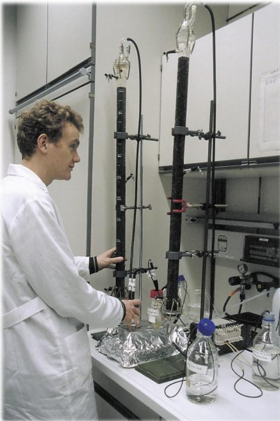
**Bild 3a:** Laborsäulen zum anaeroben mikrobiellen Schadstoffabbau (Foto: Norma Neuheiser, UFZ)
