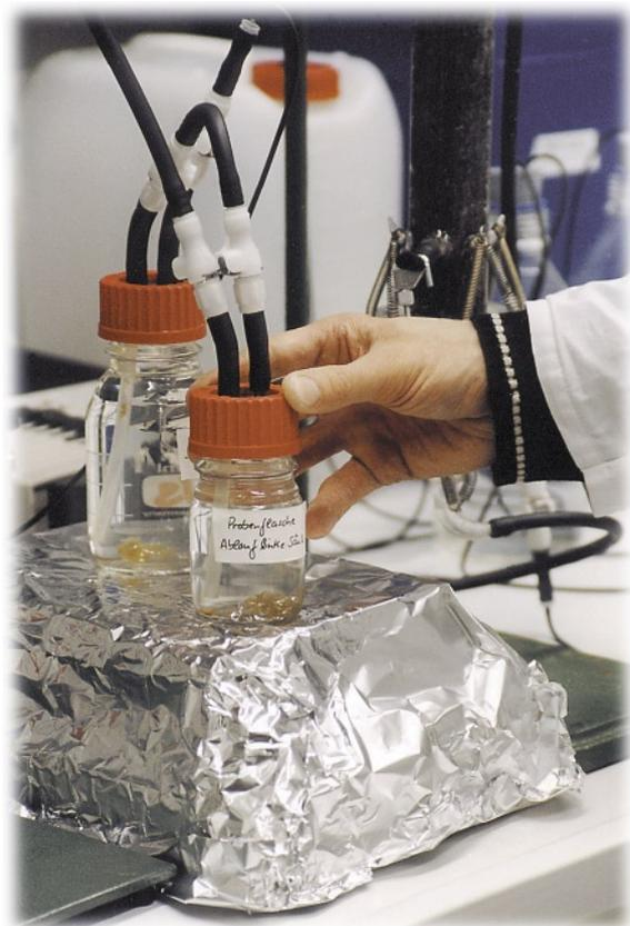
**Bild 3b:** Laborsäulen zum anaeroben mikrobiellen Schadstoffabbau, Detail (Foto: Norma Neuheiser, UFZ)
