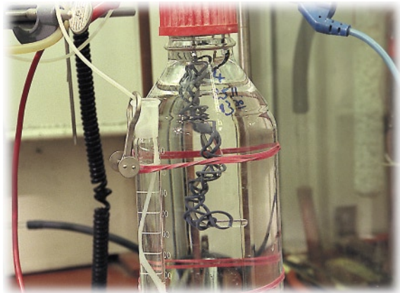
Bild 3: Membrangeschützte Katalyse im Labormaßstab (Foto: Norma Neuheiser, UFZ)
