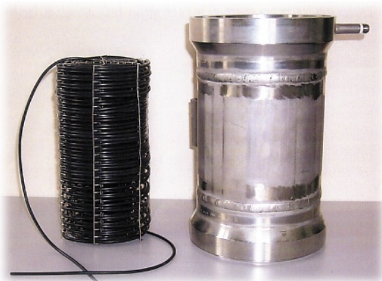
Bild 10: Membranmodul (wird derzeit vor Ort in Bitterfeld getestet; 60 m Silikonschlauch, 4,75 g Pd)
