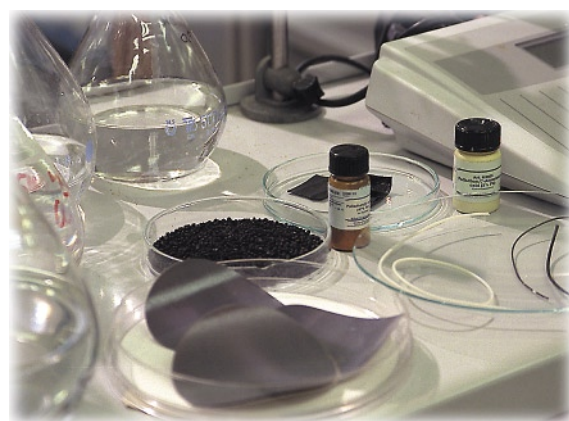
Bild 8: Flachmembrankatalysatoren, Palladium in Silikon (Foto: Norma Neuheiser, UFZ)
