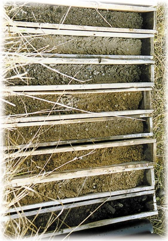
Bild 1: Bohrarbeiten zum Errichten der Grundwassermessstellen
