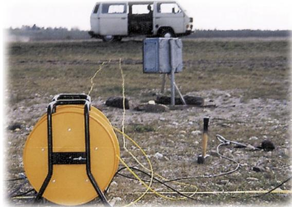
**Bild 9:** Multielektrodenanlage für SIP-Messung der Universität Leipzig am Standort SAFIRA (Foto: H.-Reinhard Gläser, UFZ)
