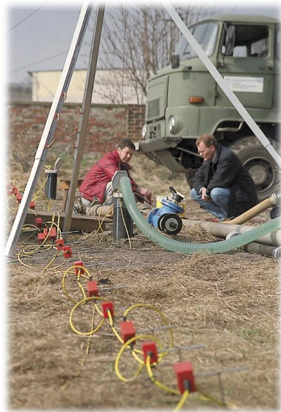
Bild 3 und 4: Messung von Fließrichtung und -geschwindigkeit des Grundwassers (Fotos: Norma Neuheiser, UFZ)
