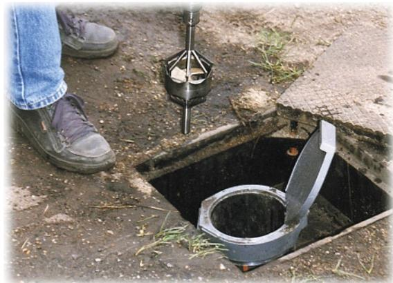
**Bild 10:** Propellerflowmeter (Foto: Ralf Trabitzsch, UFZ)
