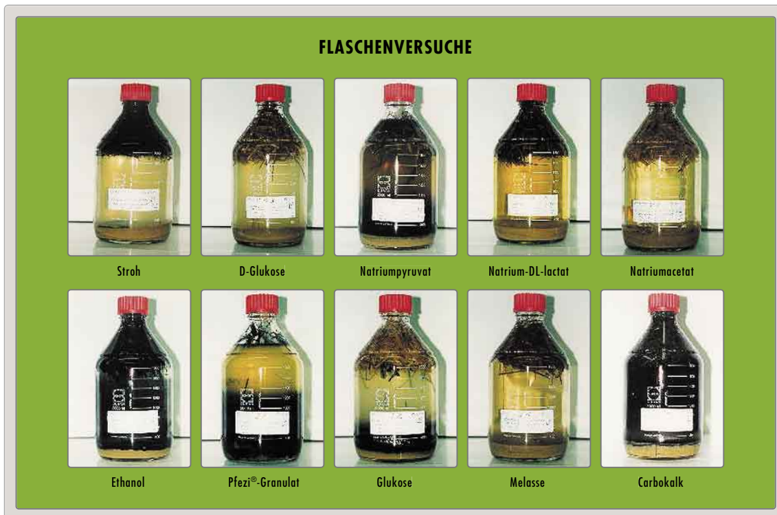
Bild 3: Bei Flaschenversuchen im Labor zur Neutralisierung des sauren Wassers und Sedimentes erwies sich eine Mischung aus Stroh und Carbokalk, einem Abfallprodukt aus der Zuckerindustrie, als die am besten geeignete. Der Carbokalk enthält alle Nicht-Zuckerstoffe der Rüben, die im Laufe der Zuckergewinnung durch Kalkfällung abgetrennt werden. Die damit versorgten Bakterien neutralisierten das Wasser in den Versuchsgefäßen vollständig. (Quelle: Dr. René Frömmichen, UFZ)
