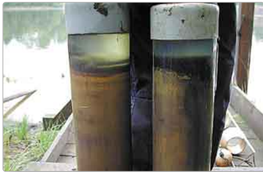
Bild 8: Die fortschreitende Neutralisierung ist gut erkennbar: Das Sediment am Grund der behandelten Enclosures ist tief schwarz und der pH-Wert über sechs, im Vergleich dazu ist das unbehandelte Sediment aus den Tiefen des Sees rostbraun und mit pH-Werten unter drei so sauer wie das Seewasser. (Quelle: Dr. Matthias Koschorreck, UFZ)
