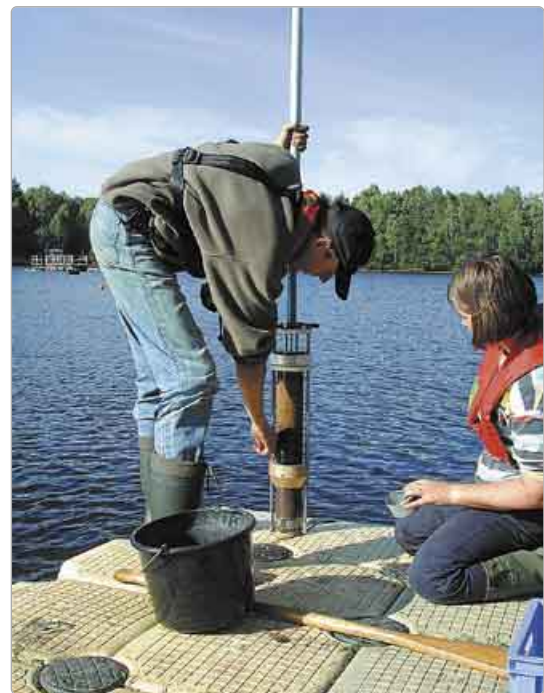
Bild 7: Zur Überwachung der Versuche entnehmen die Gewässerforscher dem See und den Enclosures regelmäßig Sedimentkerne, um die chemische Beschaffenheit, die Eisen- und Sulfatreduktionsraten und die Zahlen der beteiligten Bakterien zu bestimmen. (Quelle: Colin Brookland)
