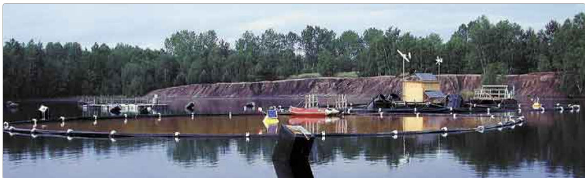
Bild 5a und b: Die beiden großen Enclosures (30 Meter Durchmesser, 5000 Kubikmeter Inhalt) – vom GKSS Forschungszentrum Geesthacht und der Firma Umweltschutz und Flachdachabdichtung GmbH Fehrbellin gebaut – fassen ein Prozent des gesamten Seevolumens. (Quelle: Dr. Matthias Koschorreck, UFZ)
