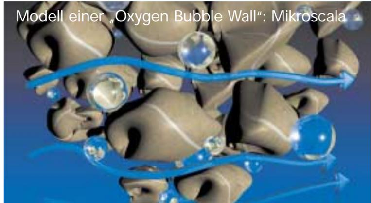
Grundwasserdekontamination durch Injektion von Sauerstoff in den Boden
