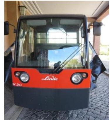
Abbildung 20: Elektrisches Multicar für innerbetriebliche Transporte
