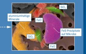
Bilder 3 und 4 | Korrelation von Heliumionenmikroskop und Röntgenspektroskopie (HIM-EDX Overlay)
