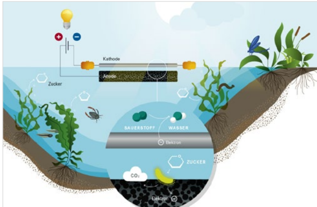
Schemazeichnung der mikrobiellen Brennstoffzelle am UFZ-Teich in Leipzig. Grafik: Artkolchase
