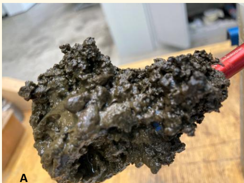
Abbildung 2. Biomasse auf dem Trägerkörper aus dem mesophilen (A) und dem thermophilen Festbettreaktor (B)
