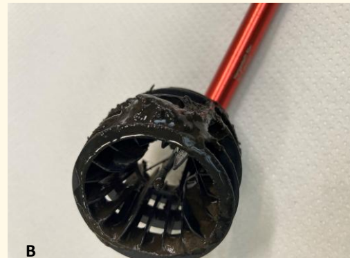
Abbildung 2. Biomasse auf dem Trägerkörper aus dem mesophilen (A) und dem thermophilen Festbettreaktor (B)
