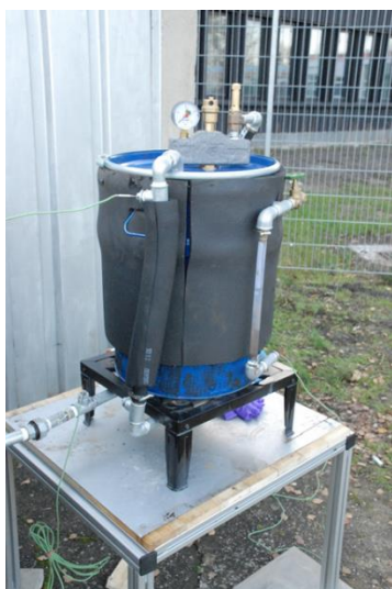
Abbildung 17: Hygienisierungsstufe der Demonstrationsanlage: kompletter Aufbau aus Hygienisierungsreaktor (links im Bild oben) und Dampferzeuger (rechts im Bild oben), Dampferzeuger (unten links.), Rohrschlange an der Unterseite des Dampferzeugers zur Dampfüberhitzung (unten rechts).
