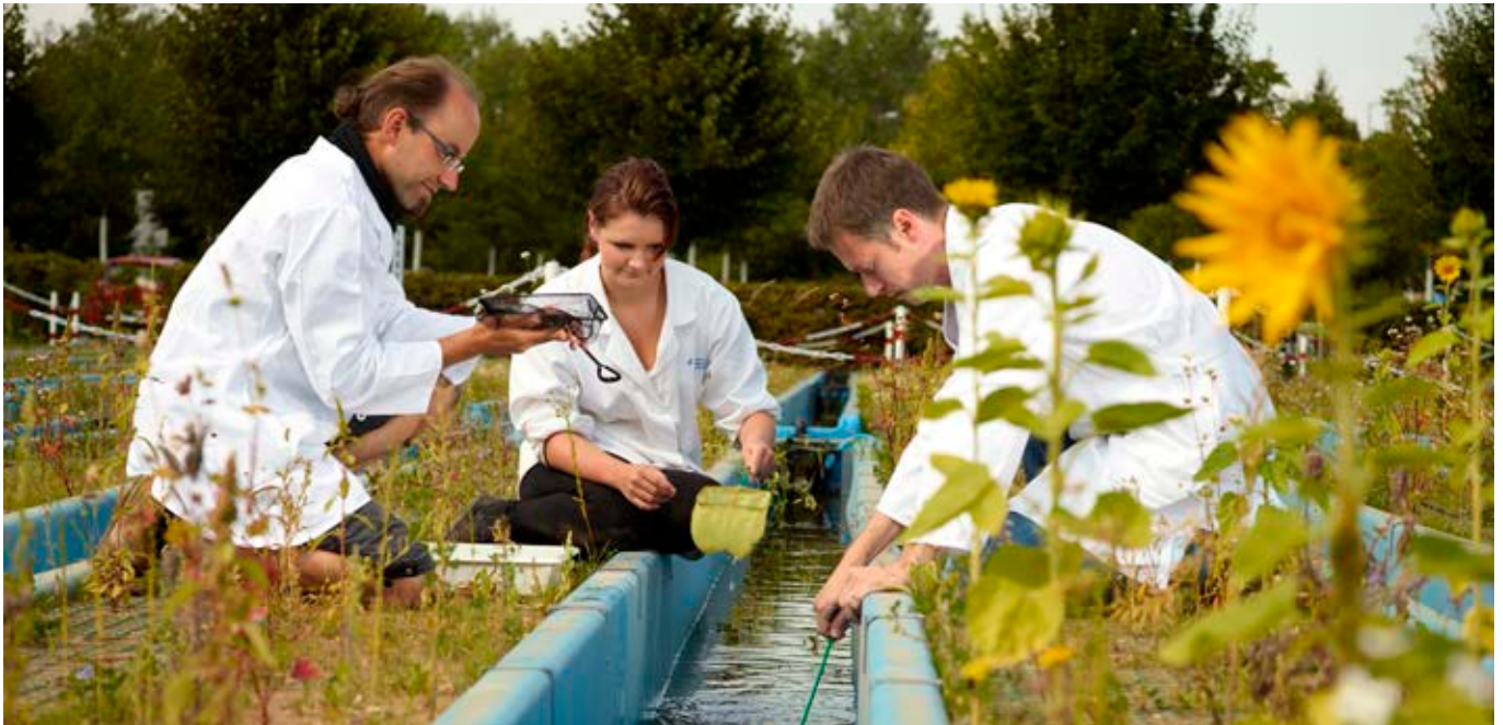
Das Flussexperiment des UFZ mit 47 jeweils 14 Meter langen künstlichen Fließbrinnen trägt dazu bei, die Wirkung von Pestiziden auf Wasserlebewesen unter deutlich realeren Bedingungen als im Labor zu erforschen.
