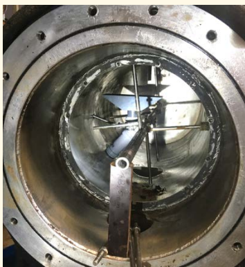
Eingebauter Trichter, um den Schaum aufzufangen und ihn aus dem Reaktor zu leiten, damit er nicht die Sensoren und Rohre des Systems verstopft.
