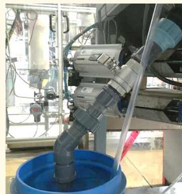
Eingebauter Trichter, um den Schaum aufzufangen und ihn aus dem Reaktor zu leiten, damit er nicht die Sensoren und Rohre des Systems verstopft.
