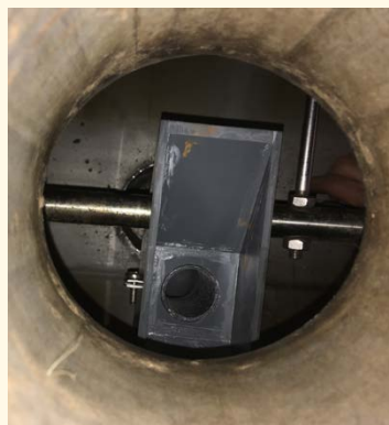
Eingebauter Trichter, um den Schaum aufzufangen und ihn aus dem Reaktor zu leiten, damit er nicht die Sensoren und Rohre des Systems verstopft.
