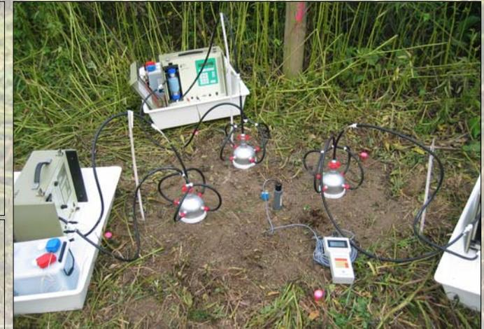
Abb. 2: Experimenteller Aufbau zur Quantifizierung der Quecksilberverflüchtigung aus Böden unter Freilandbedingungen (Foto: Stubbe, 08.2005)
