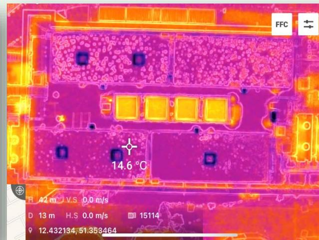
Foto: Bestimmung der Oberflächentemperatur mittels Infrarot-Kamera am 18. Januar 2021
