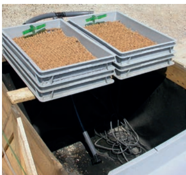
Abb. 19, 20, 21: Versuchsaufbau links (19): je 2 Filtermodelle (Tabletts) wurden pro Kiste mit 2 ° Gefälle aufgestellt. Hinten ist die Wassereinspeisung (je zwei Einlässe pro Tablett) zu sehen. Vorn wurden die Tabletts knapp über der Vegetationstragschicht gelocht. Mitte (20): Das untere Tablett wurde mit je einem Temperaturfühler bestückt. rechts (21): Mit der Variante „Reichmoor“ bepflanzte Tabletts (Fotos: Kircher/Thon).
