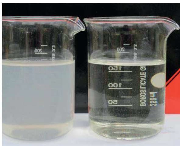
Zu- und Ablauf bei der Grauwasserbehandlung mit Sumpfpflanzen.
