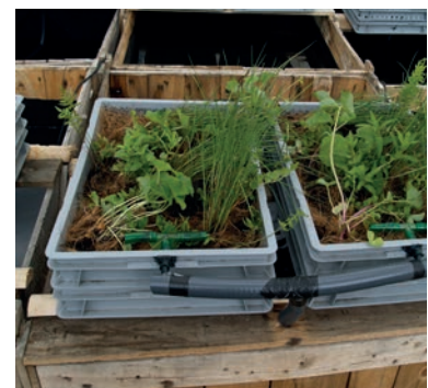
Abb. 19, 20, 21: Versuchsaufbau links (19): je 2 Filtermodelle (Tabletts) wurden pro Kiste mit 2 ° Gefälle aufgestellt. Hinten ist die Wassereinspeisung (je zwei Einlässe pro Tablett) zu sehen. Vorn wurden die Tabletts knapp über der Vegetationstragschicht gelocht. Mitte (20): Das untere Tablett wurde mit je einem Temperaturfühler bestückt. rechts (21): Mit der Variante „Reichmoor“ bepflanzte Tabletts (Fotos: Kircher/Thon).
