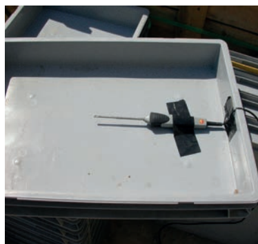
Abb. 19, 20, 21: Versuchsaufbau links (19): je 2 Filtermodelle (Tabletts) wurden pro Kiste mit 2 ° Gefälle aufgestellt. Hinten ist die Wassereinspeisung (je zwei Einlässe pro Tablett) zu sehen. Vorn wurden die Tabletts knapp über der Vegetationstragschicht gelocht. Mitte (20): Das untere Tablett wurde mit je einem Temperaturfühler bestückt. rechts (21): Mit der Variante „Reichmoor“ bepflanzte Tabletts (Fotos: Kircher/Thon).
