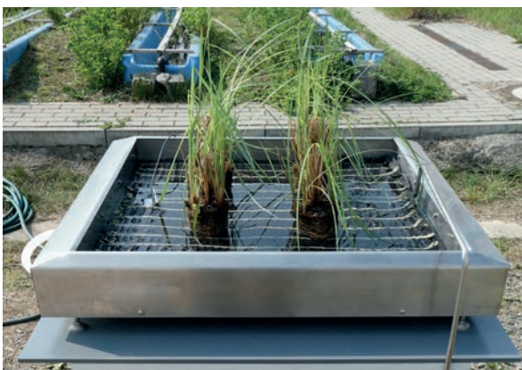
Abb. 3: Sumpfpflanzen ( Carex acutiformis ) in einem Flachlysimeter mit feuchteabhängiger Bewässerungsregelung, Wasserbilanzierung und Temperaturmessung (Foto: A. Zehndorf).
