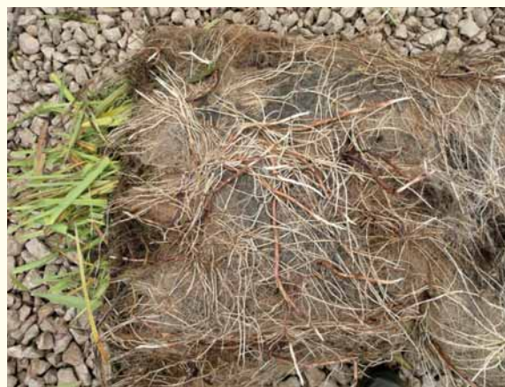
Abb. 8: Durchwurzelte Vegetationsmatte (Foto: M. Blumberg).
