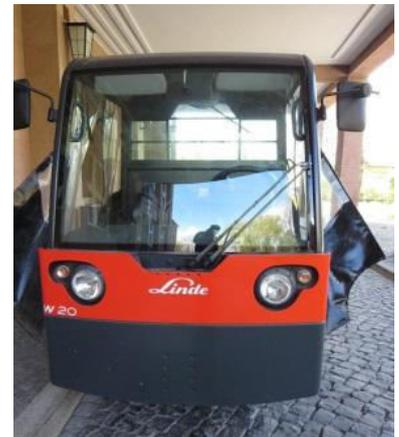
Abbildung 19: Elektrisches Multicar für innerbetriebliche Transporte
