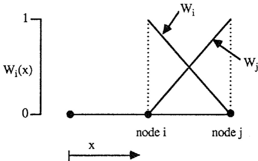
Abbildung: Interpolationsfunktion für die Galerkin-Methode nach Istok (1989)
