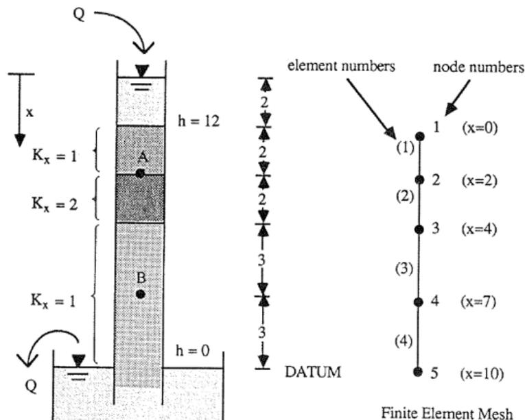
Abbildung: Bodensäulenmodell zur Erläuterung der FE Methode nach Istok (1989)
