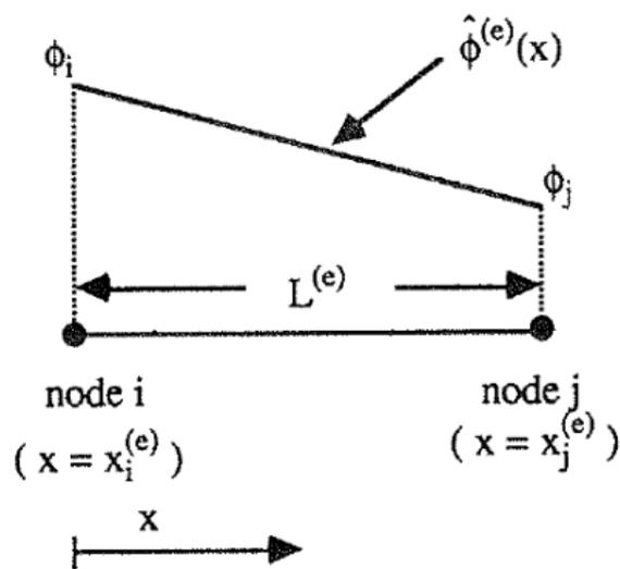
Abbildung: Interpolierte Näherungslösung auf einem 1D Element nach Istok (1989)
