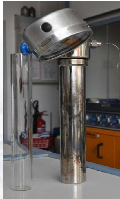
200 ml Autoklav, mechan. gerührt (UFZ-Labor)
