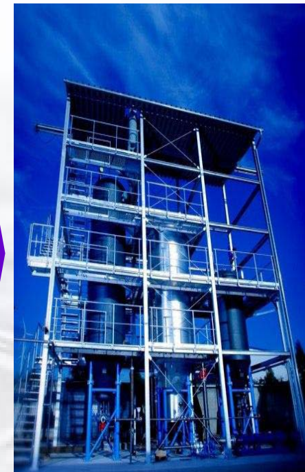
14,4 m 3 Reaktoren mit Dampfstrahlmischer (AVA-CO 2 , Karlsruhe)
