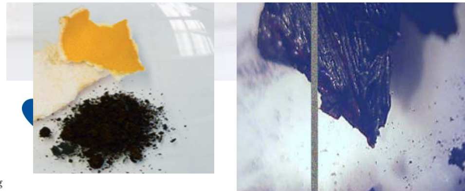
Abbildung 12: a) das Laub vor der Karbonisierung b) nach der Karbonisierung
