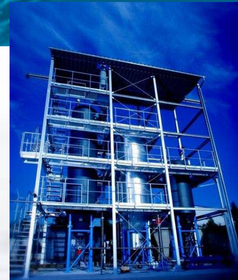
Erste industrielle HTC- Anlage in Karlsruhe
