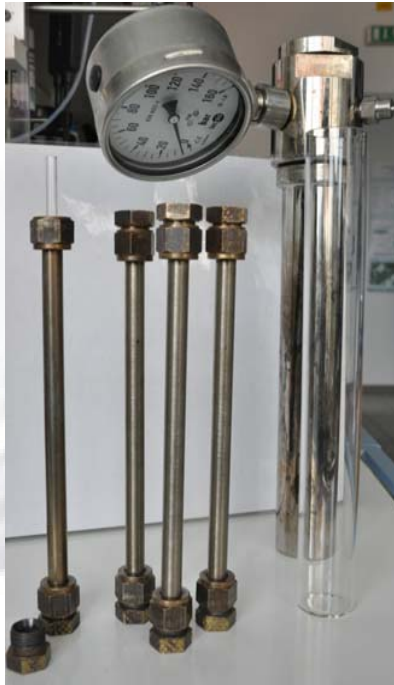
5 ml Druckrohre mit Glaseinsatz (Eigenbau)
