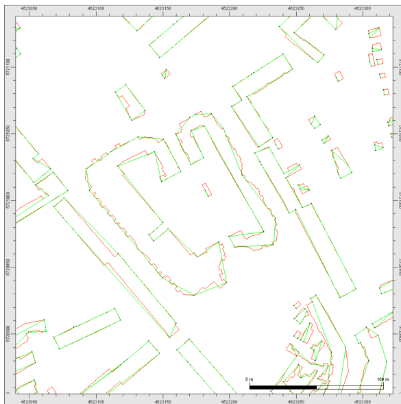
Abb. 3-3 Beispiel für die Vereinfachung von Hausgrundrissen zur Gittergenerierung
