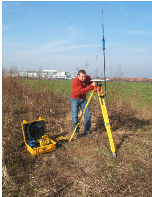
Abb. 1-5 Einmessung von Geländeprofilen mit dem GPS
