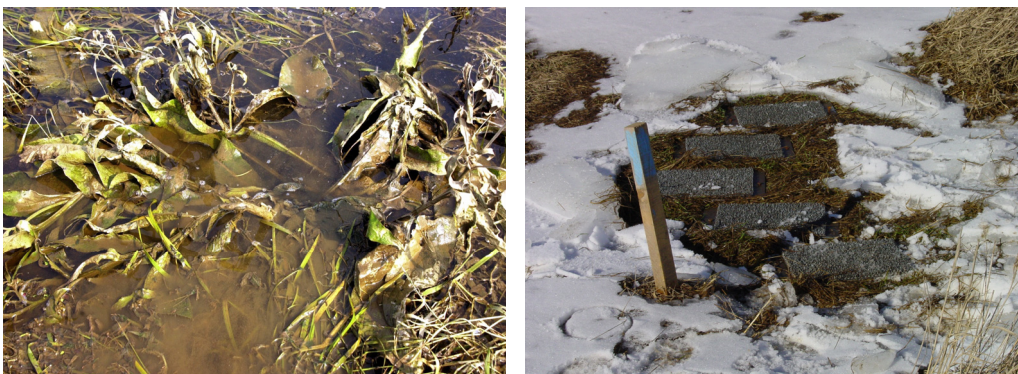
Abb. 2-5 Zur Bestimmung der Schwebstoffablagerung in der Aue (links) verwendete künstliche Sedimentfallen (rechts) nach Krüger et al. (2006)
